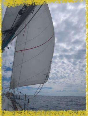
Le génois est la plus grande des voiles d'avant. On l'installe quand le vent vient de face ou de travers.
